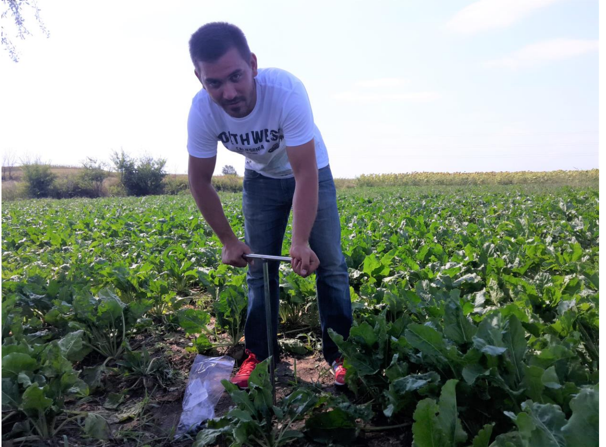
Şekil 3.4. Gravimetrik yöntemle toprak nem örneklerinin alınmasına ait görüntü
