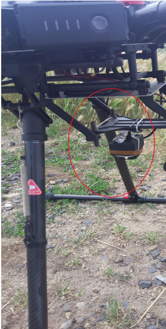
Şekil 3.2. Parrot Sequoia multispektral kamera görüntüsü
