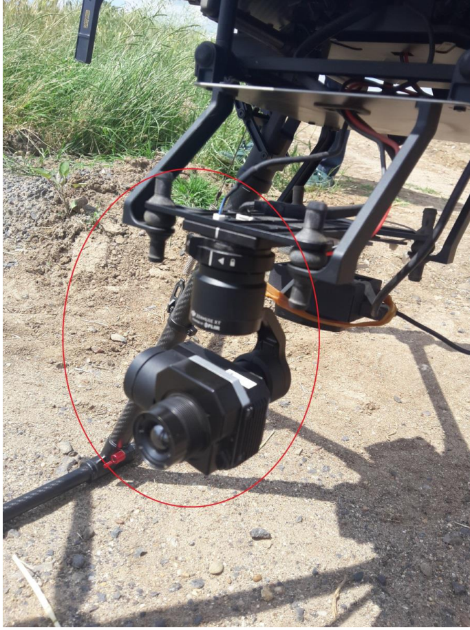
Şekil 3.3. Zenmuse XT termal kamera görüntüsü
