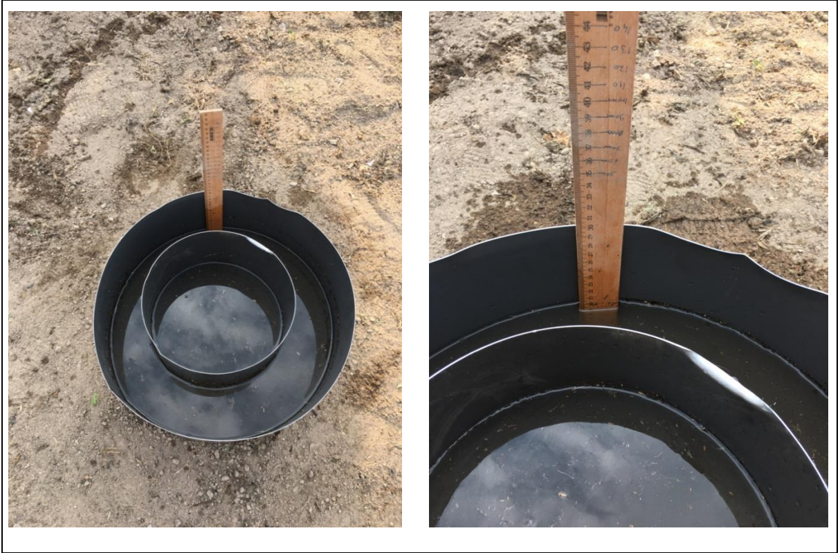
Şekil 3.4. Su ile doldurulmuş çift silindirli infiltrometre
