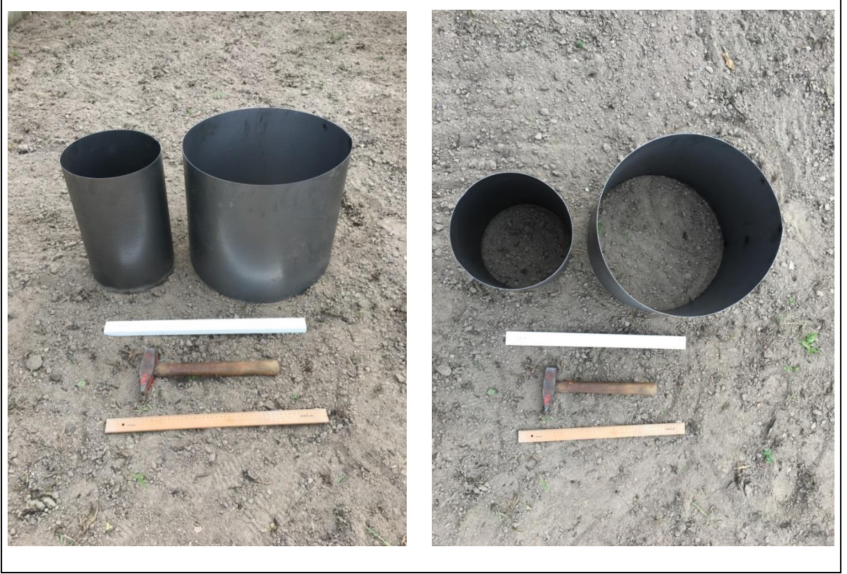
Şekil 3.2. Çift silindirli infiltrometre
