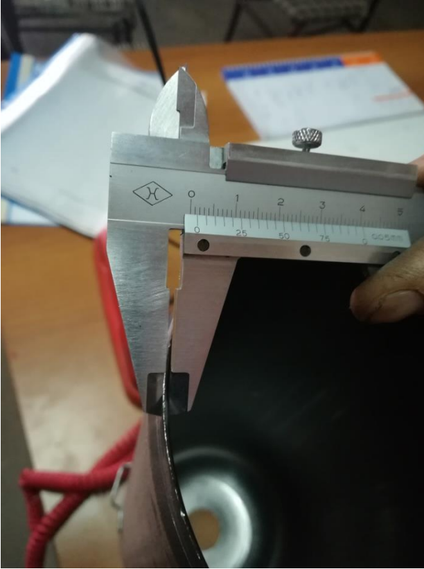
Şekil 3.3. Silindir gövde kumpas ile ölçüm
