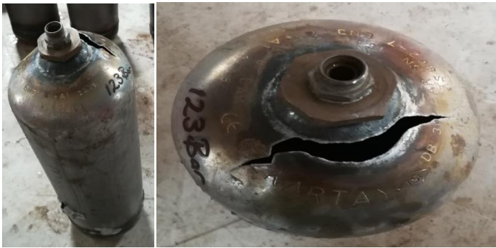
Şekil 4.15. Üç numaralı tüpün patlamadan sonraki görüntüsü
