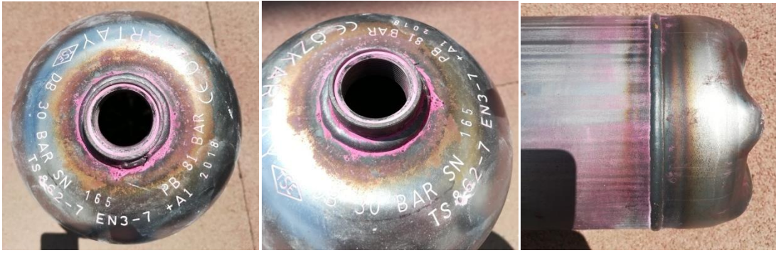
Şekil 4.6. Üç numaralı tüpün kaynak bölgelerine penetrant sıvı uygulamasının sonucu
