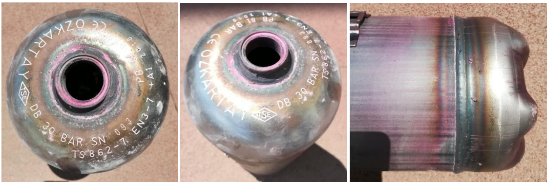
Şekil 4.7. Dört numaralı tüpün kaynak bölgelerine penetrant sıvı uygulamasının sonucu
