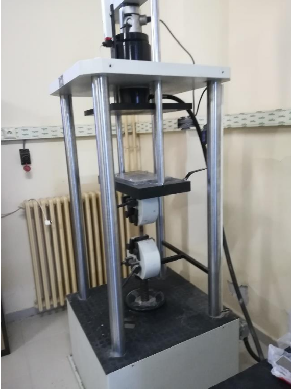
Şekil 4.25. Numunelerin çekme testine tabi tutulması
