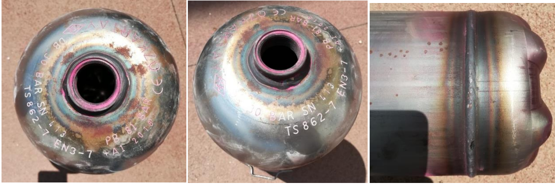
Şekil 4.11. Sekiz numaralı tüpün kaynak bölgelerine penetrant sıvı uygulamasının sonucu
