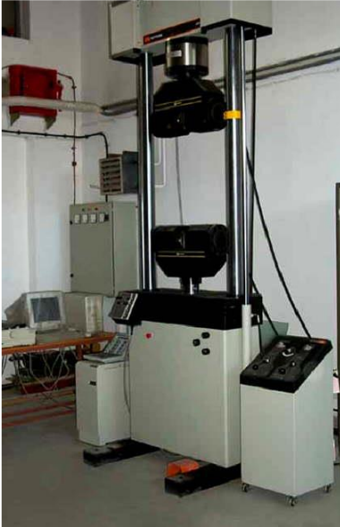
Şekil 1.10. Çekme deney makinesi (Savaşkan 2004)
