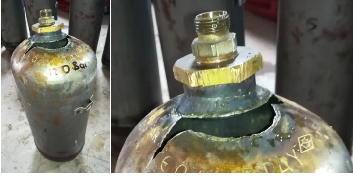
Şekil 4.13. Bir numaralı tüpün patlamadan sonraki görüntüsü
