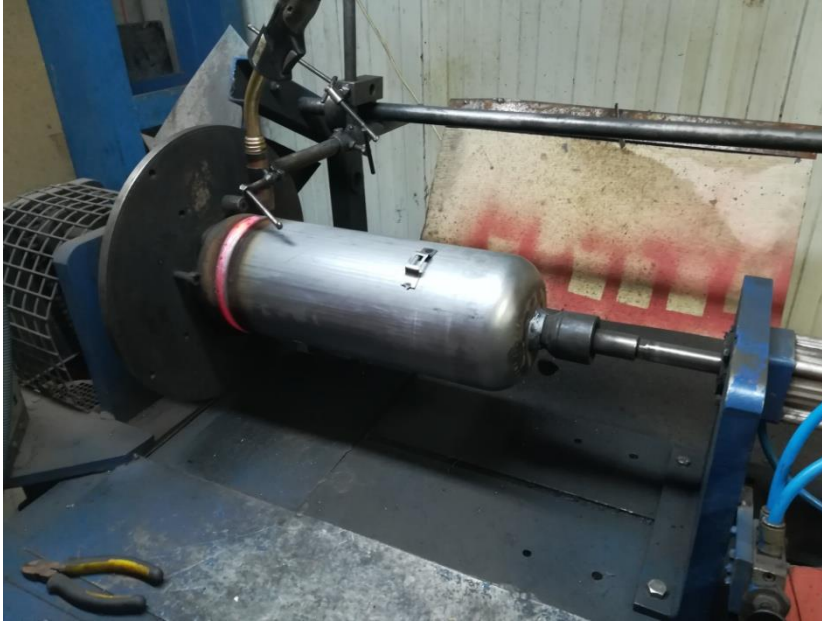
Şekil 4.1. Mag kaynak makinesine bağlanmış gövde ile üst manşonun kaynağı
