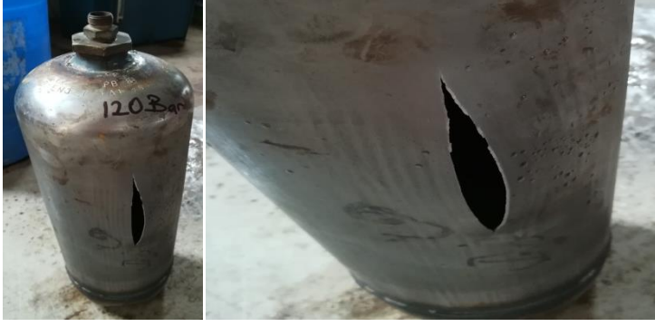
Şekil 4.19. Dokuz numaralı tüpün patlamadan sonraki görüntüsü
