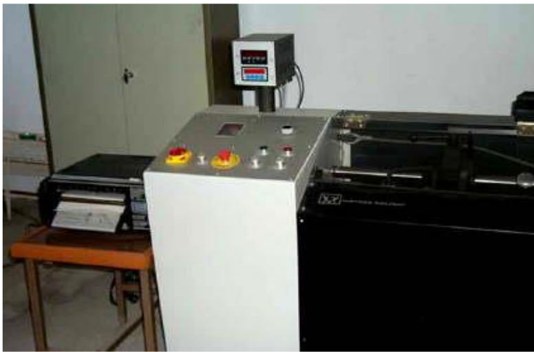
Şekil 1.13. Burulma testi makinesi (Savaşkan 2004)
