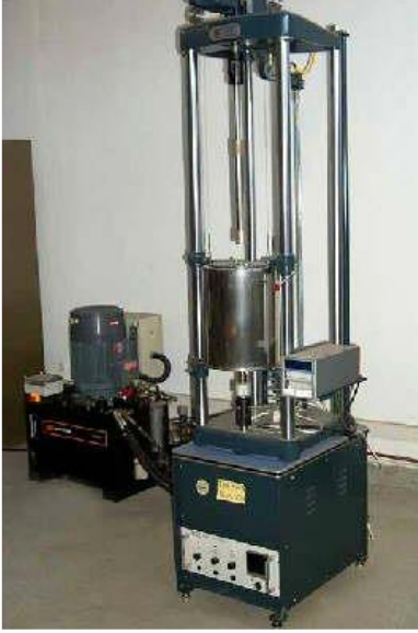
Şekil 1.11. Basma testi makinesi (Savaşkan 2004)
