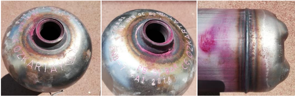
Şekil 4.4. Bir numaralı tüpün kaynak bölgelerine penetrant sıvı uygulamasının sonucu
