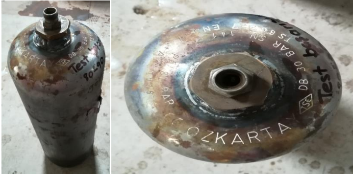
Şekil 4.17. Beş numaralı tüpün patlamadan sonraki görüntüsü
