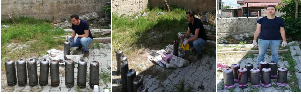
Şekil 4.3. Tüplere penetrant sıvı testinin uygulanması
