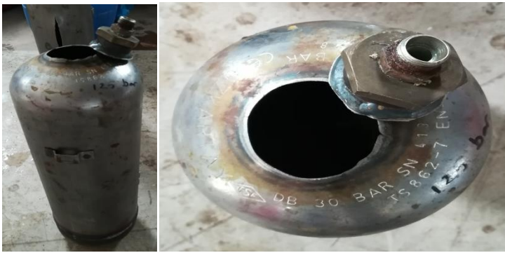
Şekil 4.18. Sekiz numaralı tüpün patlamadan sonraki görüntüsü
