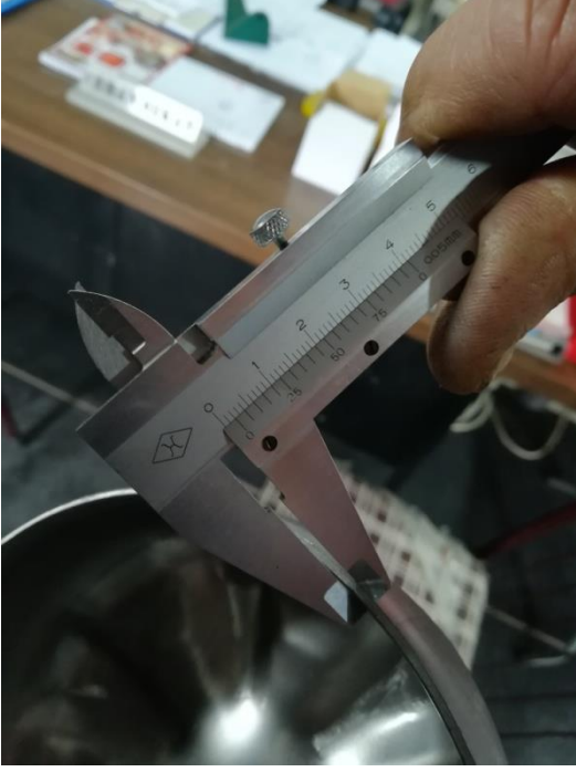
Şekil 3.4. Alt tabya kumpas ile ölçüm
