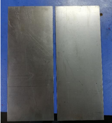
Şekil 4.20. DC 04 kalitede (Erdemir 7114) sürekli tavlama yapılmış levha çelik
