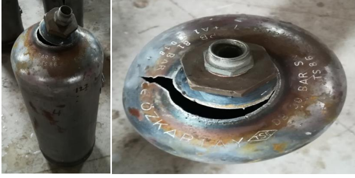
Şekil 4.16. Dört numaralı tüpün patlamadan sonraki görüntüsü
