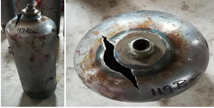
Şekil 4.14. İki numaralı tüpün patlamadan sonraki görüntüsü
