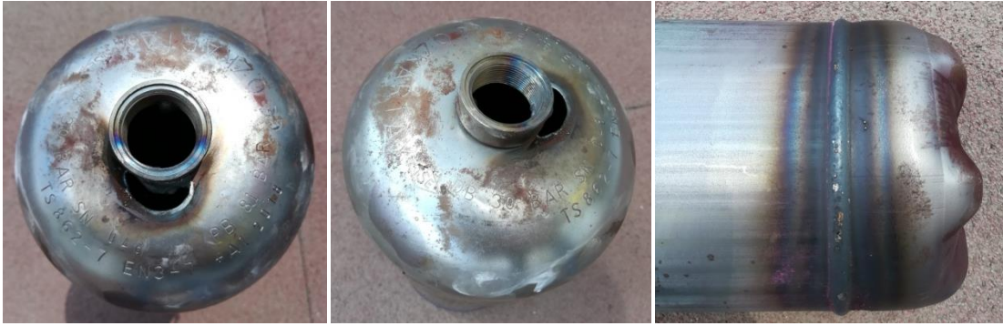
Şekil 4.9. Altı numaralı tüpün kaynak bölgelerine penetrant sıvı uygulamasının sonucu
