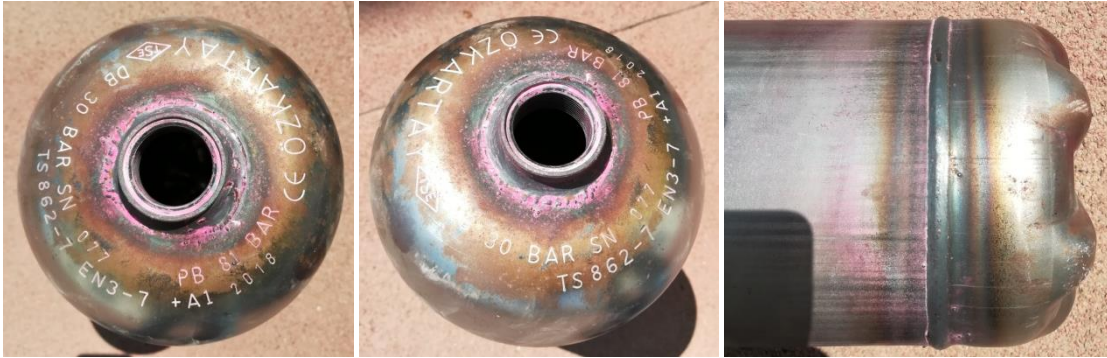
Şekil 4.12. Dokuz numaralı tüpün kaynak bölgelerine penetrant sıvı uygulamasının sonucu
