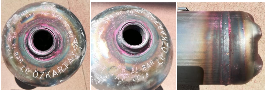
Şekil 4.8. Beş numaralı tüpün kaynak bölgelerine penetrant sıvı uygulamasının sonucu
