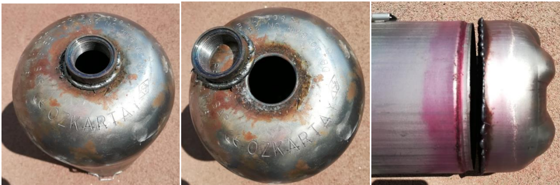
Şekil 4.10. Yedi numaralı tüpün kaynak bölgelerine penetrant sıvı uygulamasının sonucu
