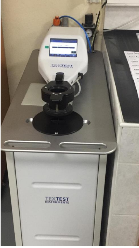
Şekil 4.19. Textest Hava Geçirgenliği Ölçüm Cihazı
