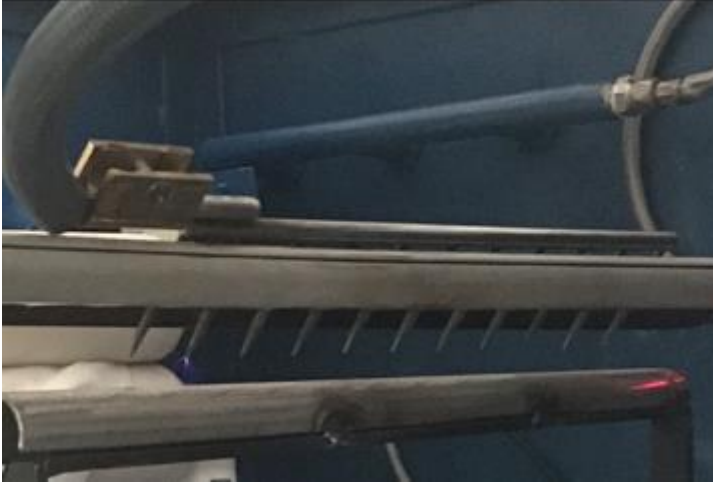
Şekil 4.15. İğne Elektrot Düzenegi
