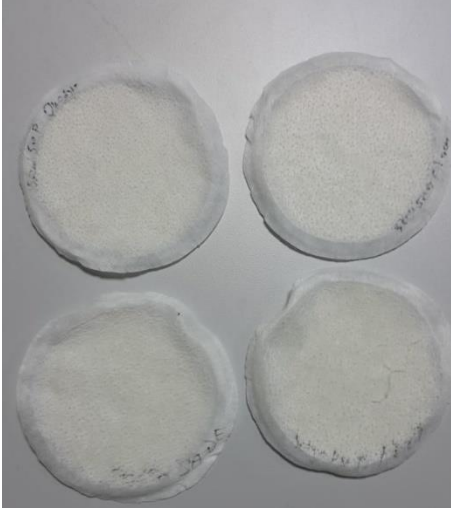
Şekil 5.22. %50 Viskon %50 Polyester Numune Kumaşın Boncuklanma Durumu
