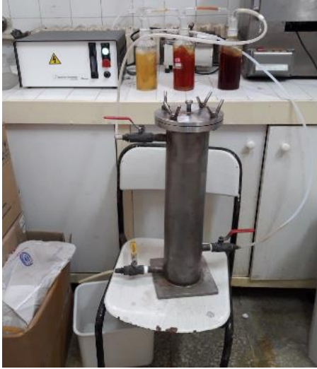
Őekil 3.4. Reaksiyon bařladıktan sonra gaz yıkama Őiřelerinde oluřan iyot ile Őeffaf zeltilerin renginin deėiřmesi
