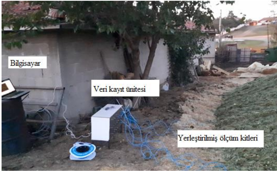
Şekil 3.6. Toprak üstü yığın siloda basınç ölçüm çalışmaları
