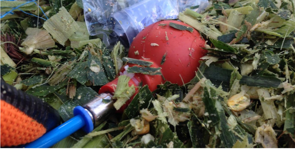
Şekil 3.7. Basınç algılayıcı kauçuk kürelerin materyal içerisine yerleştirilmesi
