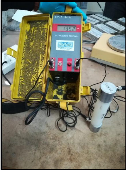
Şekil 3.11. Ultrases geçiş hızı ölçüm cihazı
