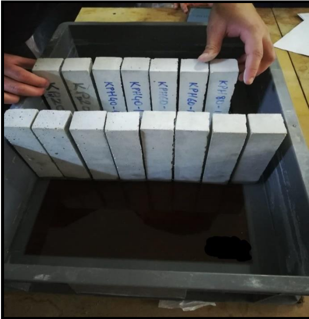
Şekil 3.14. Kılcallık katsayısı deneyi
