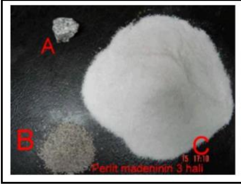
Şekil 2.5. Kayaç haldeki perlit (A), ham perlit (B) ve genişletilmiş perlitin (C) görünümü (www.pertas.com)
