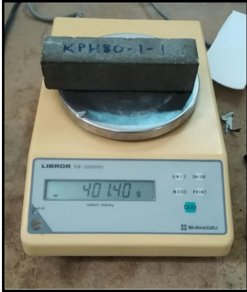
Şekil 3.15. Sertleşmiş harç numunesinin suya doymuş ağırlığının ölçülmesi
