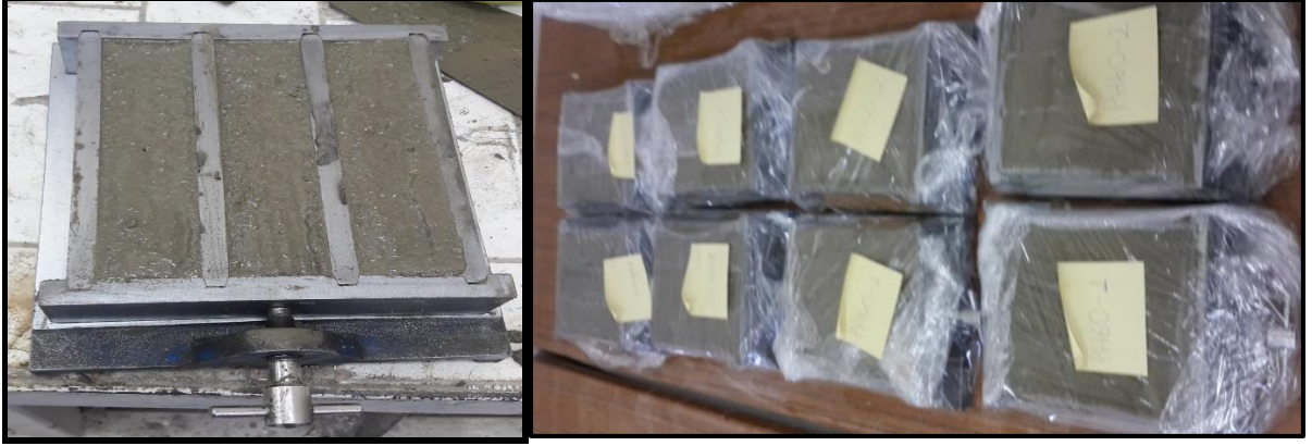
Şekil 3.7. Harç numunelerinin kalıplara yerleştirilmesi
