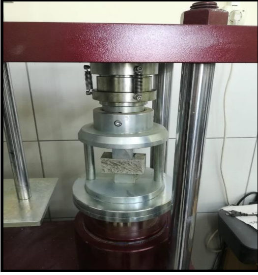
Şekil 3.10. Harç numunelerinin basınç dayanımına tabi tutulması
