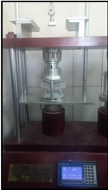
Şekil 3.9. Üç noktadan yükleme yöntemi ile eğilme dayanımı ölçümü
