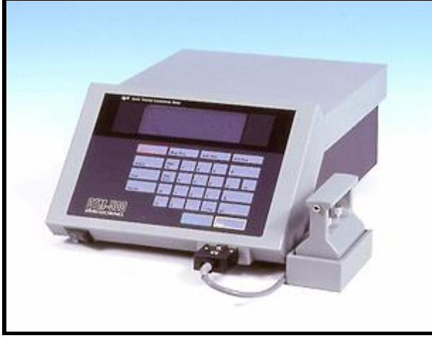
Şekil 3.16. Sertleşmiş harç numunesinin ısı iletkenlik hesap değeri ölçüm cihazı
