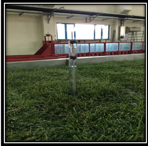
Şekil 3.6. İnfiltrometre cihazı ile yapılan çim analizi.
