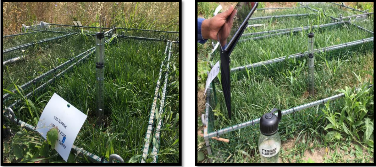
Şekil 4.12. Disk İnfiltrometre cihazının kontrol edilmesi Şekil 4. 12. a’da Disk İnfiltrometre ile infiltrasyon deneylerinin yapılması
