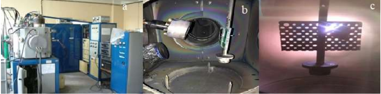
Şekil 3.13: (a) MightyMak marka dengelenmemiş magnetron kaplama cihazı (b)vakum bölgesi, hazırlanan numunelerin yerleşimi. (c) Kaplama işlemi
