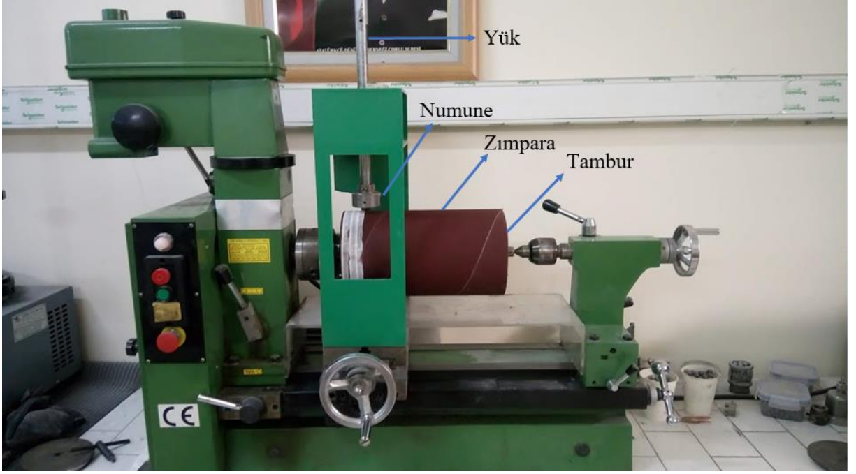
Şekil 3.5. Aşınma Testinde Kullanılan Cihaz
