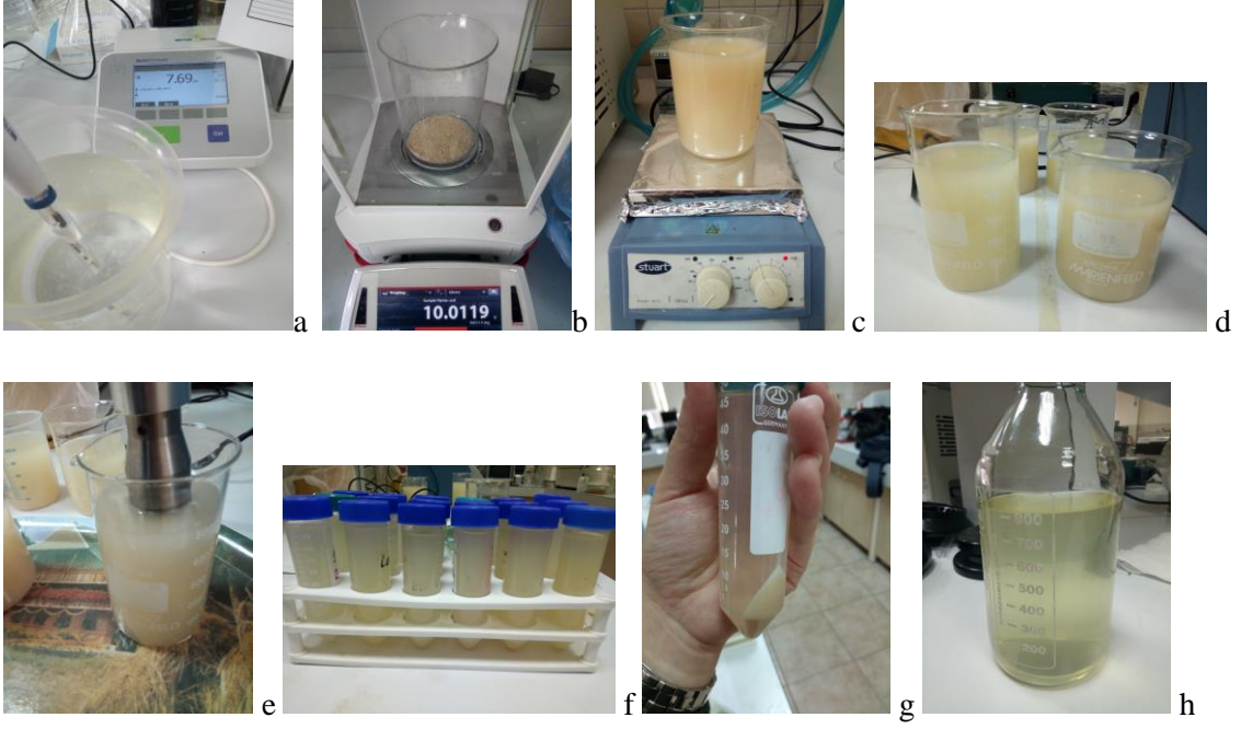
Şekil 3.1. Elek üstü mayanın hidroliz aşamaları
