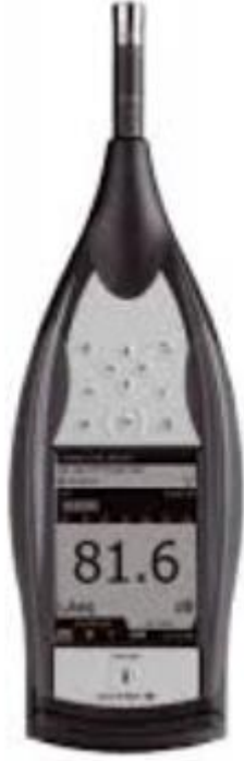
Şekil 9.4. Brüel&Kjaer 2250 Ses Seviyesi Ölçer Cihazı
