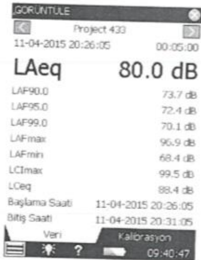
Şekil 9.7. Akşam zaman diliminde 1. Nuktada yapılan ölçüm sonucu
