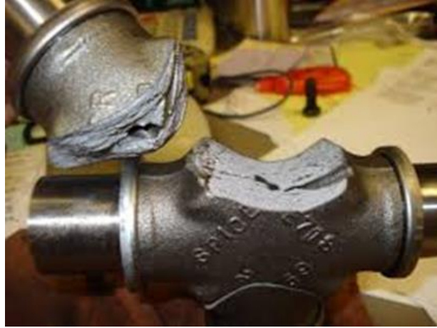
Şekil 1.23 Ani bir darbe sonucu kırılmış bir istavroz
