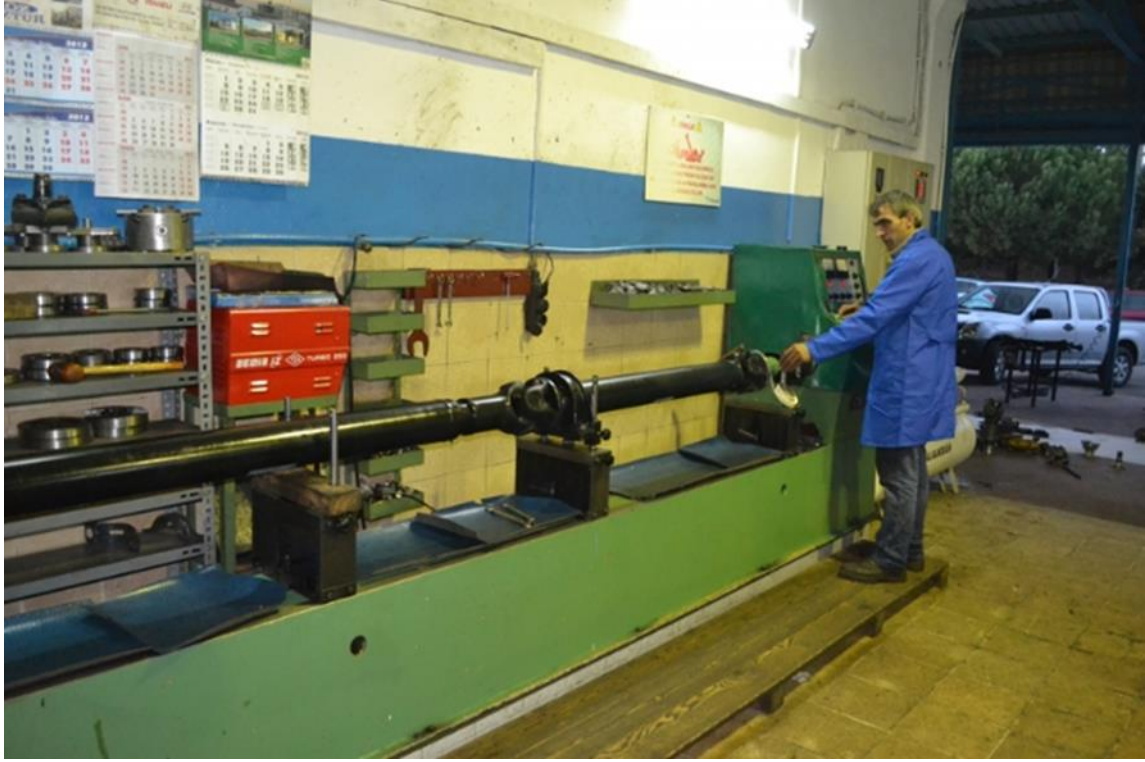
Şekil 1.21 Kardan şaftın balans işlemi
