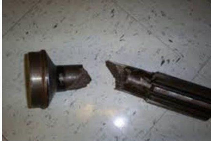
Şekil 1.27 Kayıcı milin kırılması
