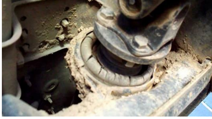
Şekil 1.25 Askı lastiğinin yırtılması
