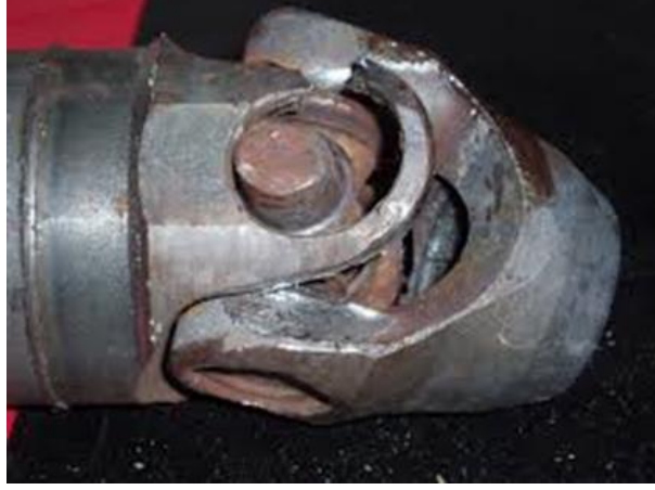
Şekil 1.22 Yağsızlık sonucunda mafsalsız istavrozun dağılması
