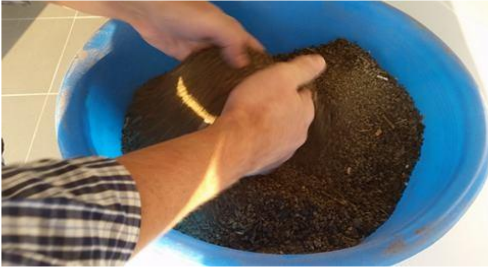
Şekil 3.4. Belirli dozdaki çöp kompostlarının toprak örneği ile karıştırılması
