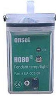
Şekil 3.10. Denemelerde kullanılan su geçirmez Hobo marka sıcaklık datalogeri
