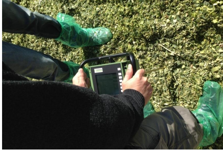
Şekil 3.9. Penetrometre ile yoğunluk ölçümü
