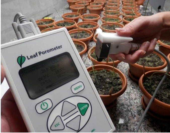
Şekil 3.3. Bitki yapraklarının stoma iletkenliđinin ölçm (Özgn)
