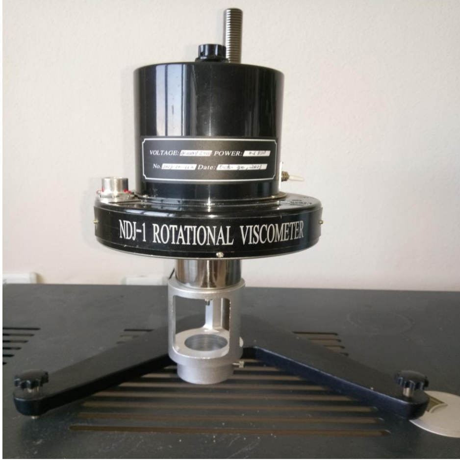
Şekil 3.5. Viskozite ölçümü NDJ-1 ROTATIONAL VISCOMETER cihazıyla yapılmıştır. (Namık Kemal Üniversitesi Ziraat Fakültesi Zootekni Bölümü)
