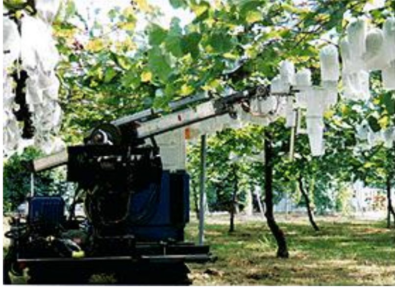
Şekil 2.1. Asmalarının torbalanması ( Monta ve ark. 1995).
