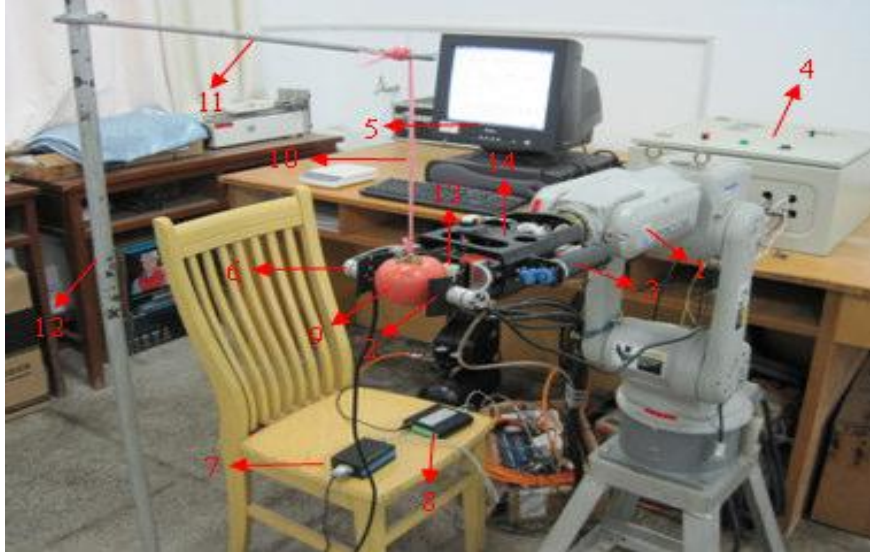
Şekil 2.42. Deney sistemi (Zhi-Guo ve ark. 2009). 1: Domates hasat robotu; 2: parmak; 3: motor; 4: kontrol kabini; 5: bilgisayar; 6: basınç sensörü; 7: sinyal düzenleyici; 8: USB5935 veri elde etme aracı; 9: domates; 10: ip; 11: eklem; 12: yükseklik ayarlayıcı; 13: emici; 14: end-effector.
