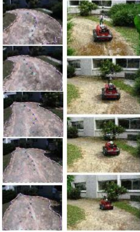
Şekil 2.34.İki küçük dizideki basit yol izlemesi.Soldaki görüntü traktörün robotun belirlediği görüntü noktaları üzerindeki hareketi.Sağdaki görüntü nokta görüntüleri (Mateus ve ark. 2005).
