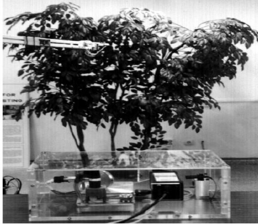
Şekil 2.5. Lazerle bulma yönteminin temel alındığı robotik meyve hasadı (Jimenez ve ark. 2000).
