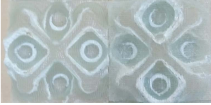
Şekil 4.23. Federli konik yapılı çekirdek basma testi sonrası görünüm
