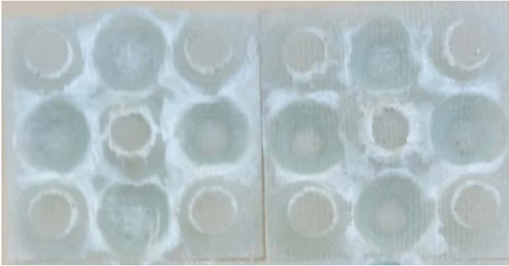
Şekil 4.22. Konik yapılı çekirdek basma testi sonrası görünüm
