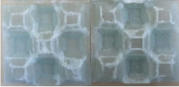
Şekil 4.21. Piramit yapılı çekirdek basma testi sonrası görünüm
