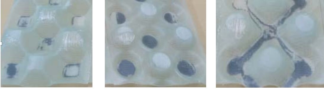
Şekil 4.7. Epoksi reçine çekirdek ayrılması
