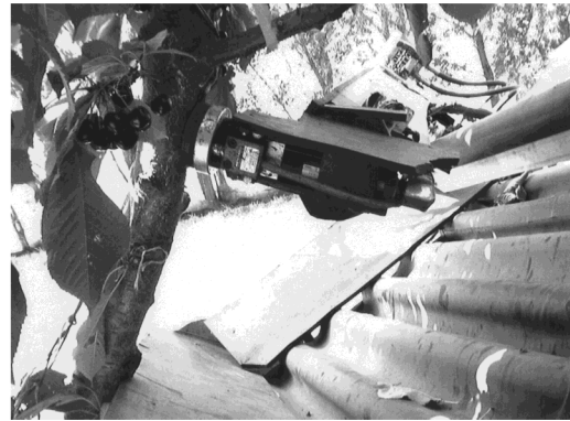
řekil 2.1. Geliřtirilmiř olan kiraz hasat makinası (Peterson ve Wolford 2001)
