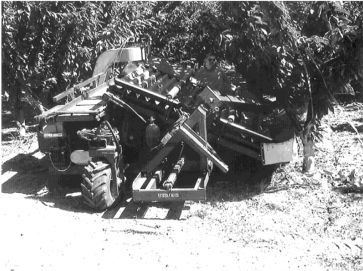
řekil 2.1. Geliřtirilmiř olan kiraz hasat makinası (Peterson ve Wolford 2001)
