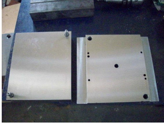
Şekil 3.4. Erkek ve dişi kalıpların seçimi ve ana hatlarının oluşturulması
