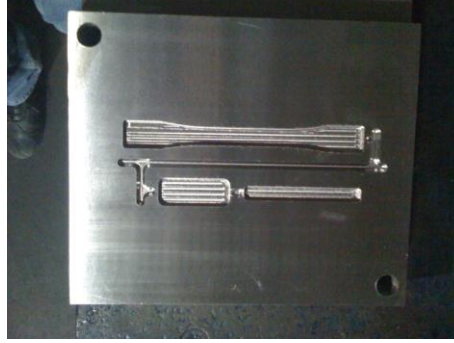
Şekil 3.7. Kalıp yolluklarının açılmış hali
