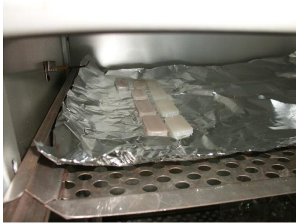
Şekil 4.5. 140°C ‘de kurutulan akıllı ambalaj deney örnekleri
