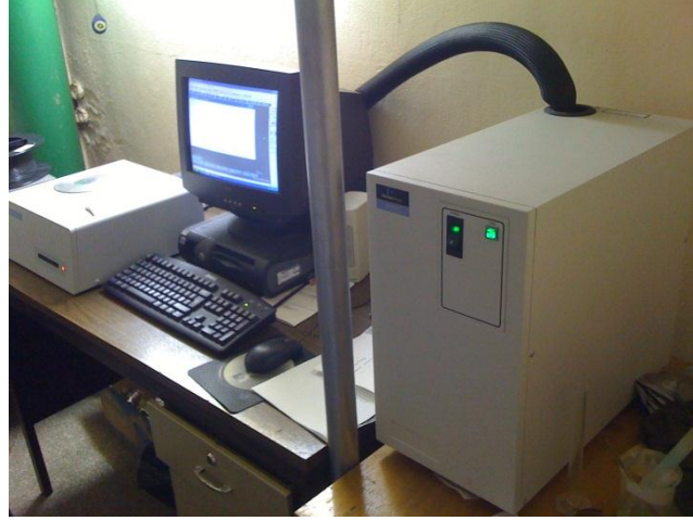
Şekil 3.19. Diferansiyel taramalı kalorimetre deney düzeneği
