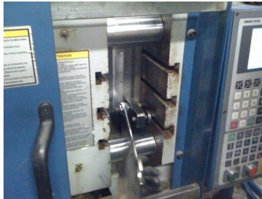
Şekil 3.10. Kalıbın enjeksiyon makinesine bağlanması
