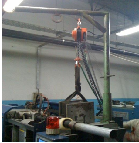
Şekil 3.9. Kalıbın enjeksiyon makinesine indirilmesi
