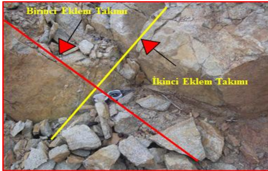
Şekil 5.4. Balya güneydoğusunda yüzeyleyen Karakaya Kompleksi'nin Hamuru konumunda olan kumtaşlarında görülen eklem sistemi(Yümün 2017)
