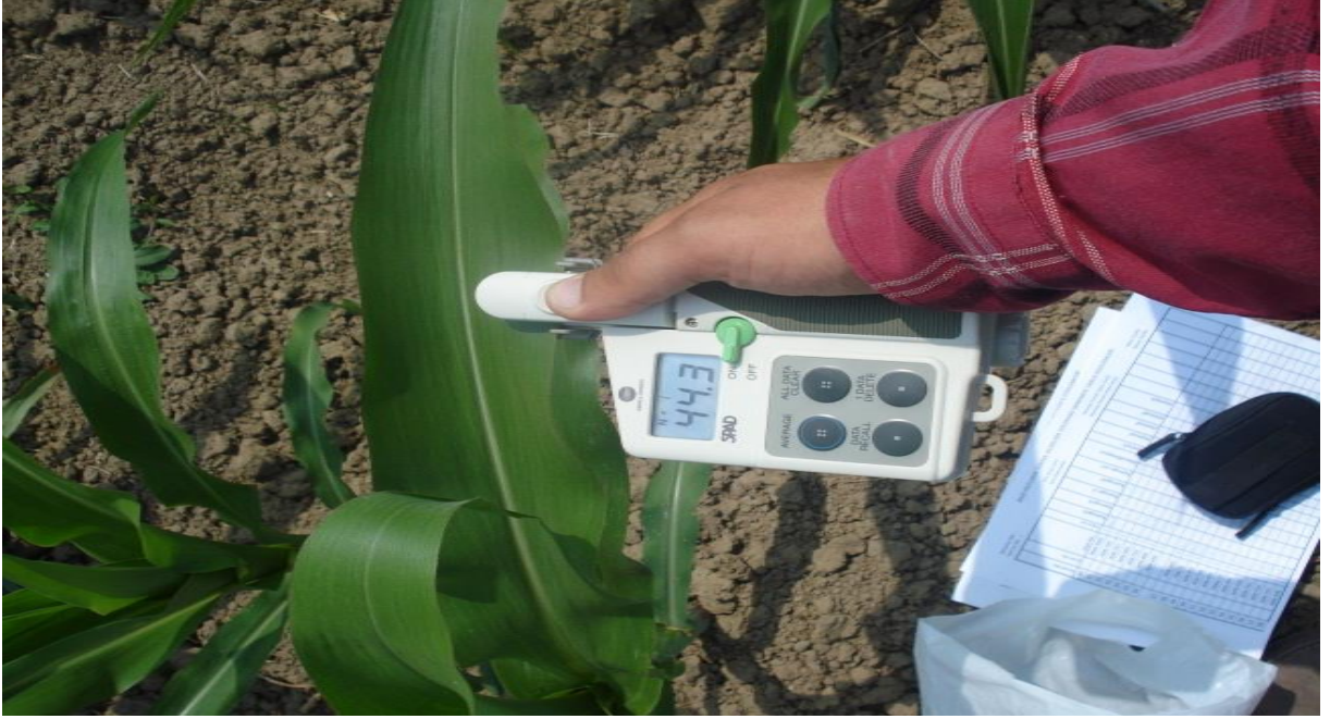
Şekil A.7. Minolta SPAD-502 Klorofilmetre ile SPAD ölçümü
