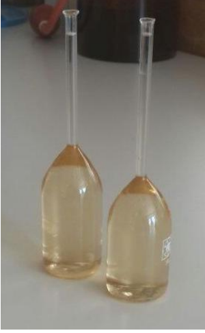
Şekil 3. 13. Piknometre İle Yoğunluk Tayininde Piknometre Görüntüsü
