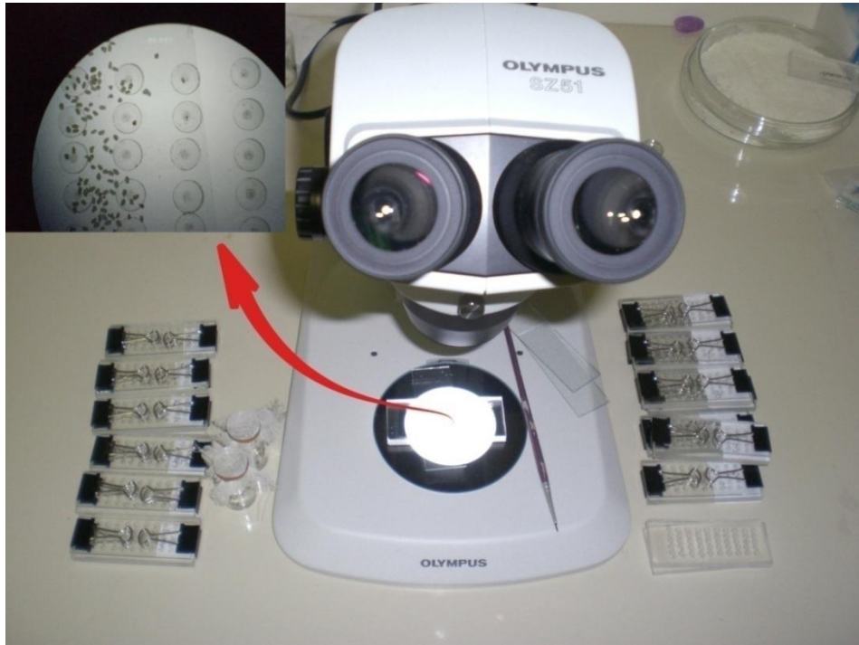
Şekil 3.2. Yumurtaların stereozoom binoküler mikroskop altında mikadan yapılmış slayt üzerindeki hücrelere aktarılışı
