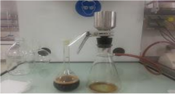
Şekil 3.2 1000 mg/L'lik stok humik asit çözeltisinin 0.45 mikron filtreden süzülmesi işlemi.
