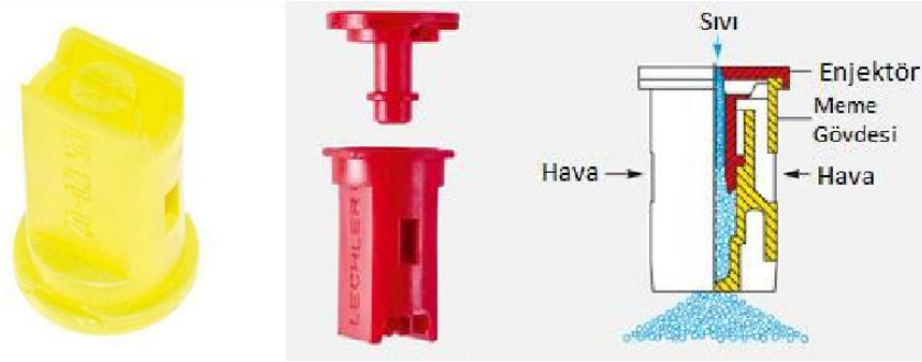
Şekil 3.1. Lechler IDK 12002 hava enjektörlü püskürtme memesi (Anonim)
