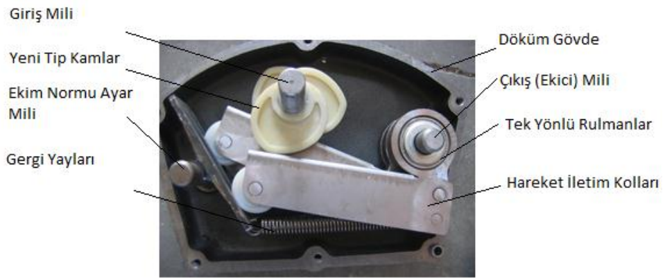
Şekil 3.2. Yeni tip transmisyon şematik resmi
