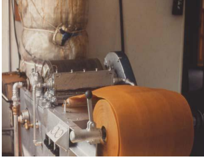
Şekil 2.6.1.3. Temel peteğin basım makinasından çıkmış görüntüsü (Şekerden 2000).
