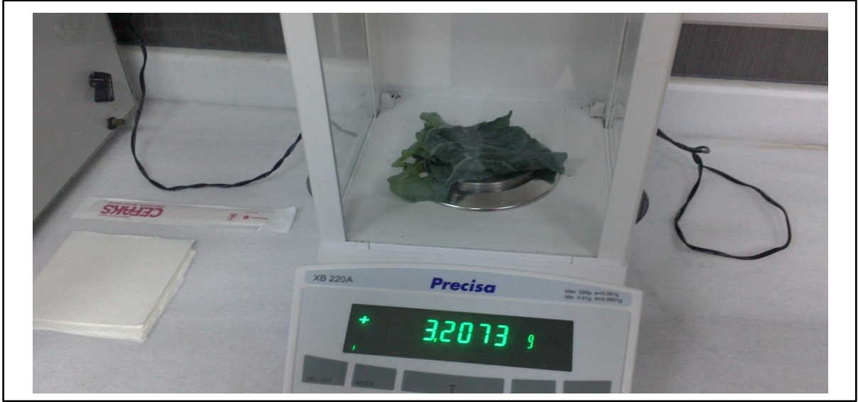
Şekil 3.12. Yaprak lahanası bitkisinin 2 cm'den uzun yaprak ağırlıklarının hassas terazide tartılması
