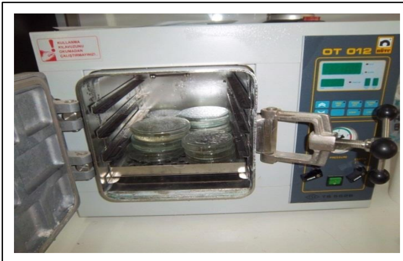
Şekil 3.8. Yaprak lahanadan 17 mm çapında alınan disklerin bulunduğu petri kaplarının otoklavda 100°C'de 10 dakika bekletilmesi
