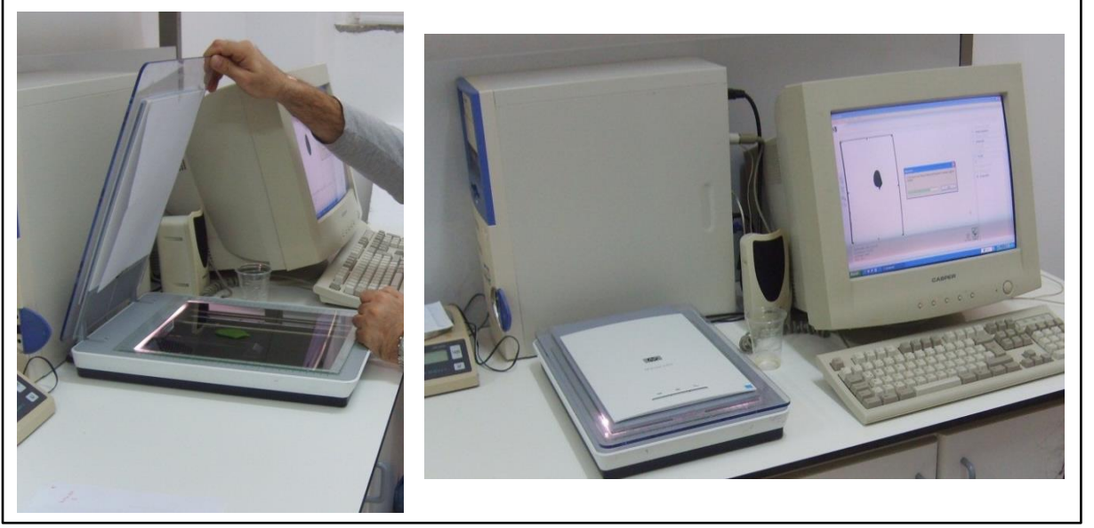
Şekil 3.14. Yaprakların tarayıcıdan geçirilip yaprak alanı programına aktarılması
