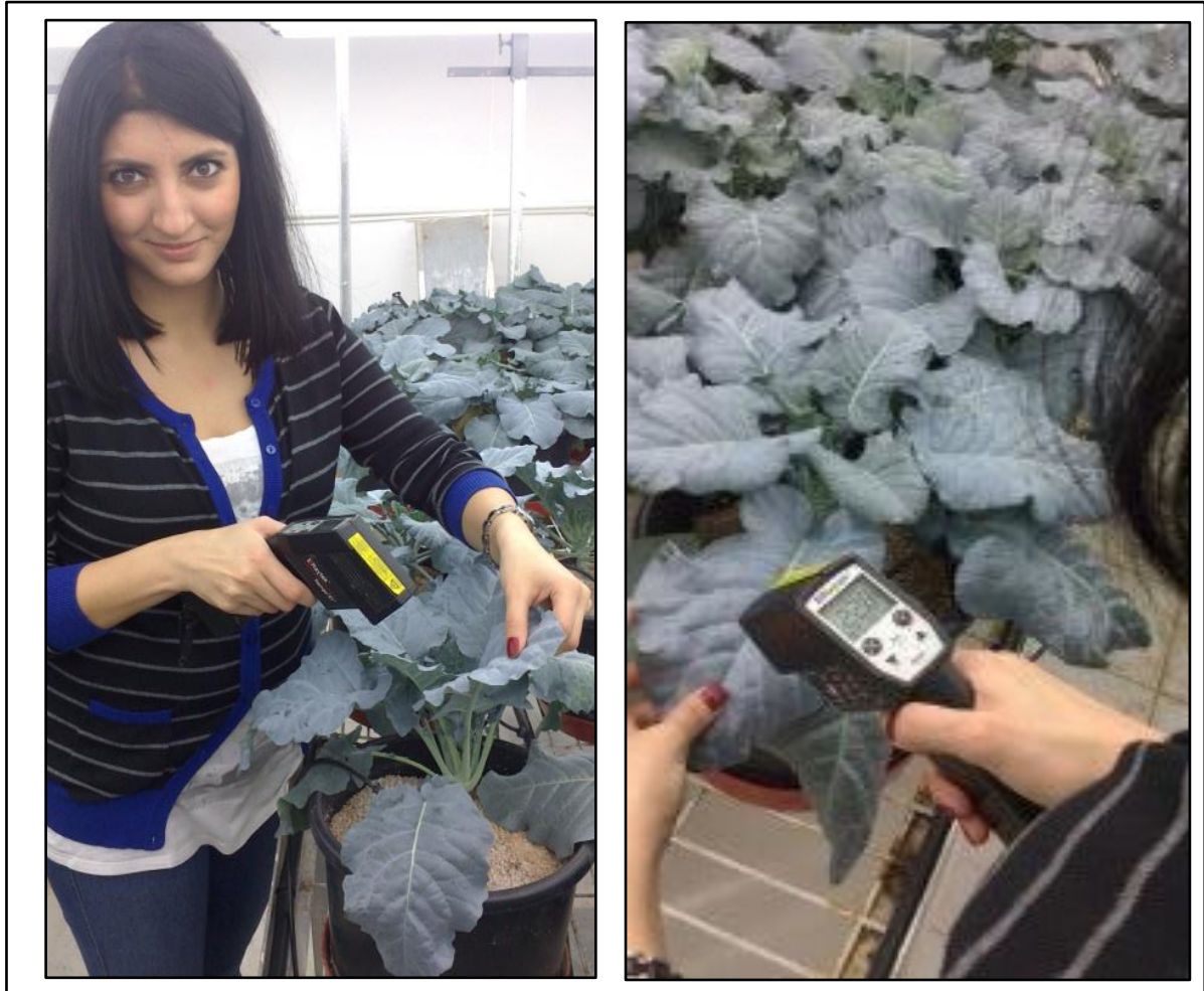
Şekil 3.9. Infrared termometre yardımıyla yaprak lahanası yüzey sıcaklığının ölçümü
