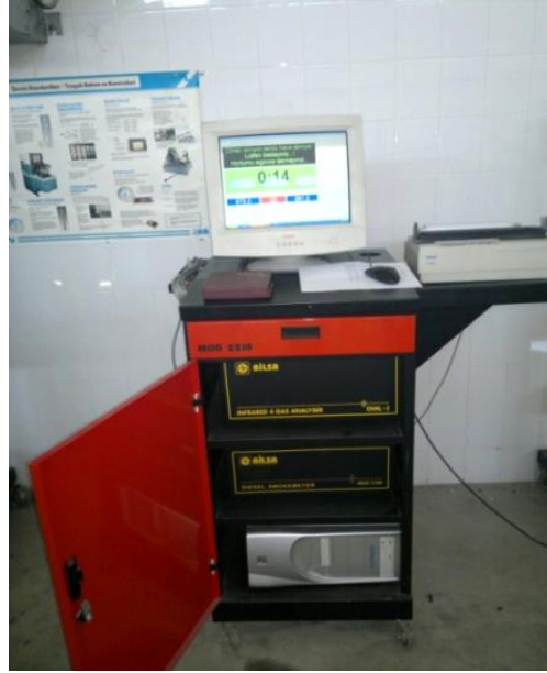
Şekil 3.6. Mod 2200 egzoz emisyon gaz analizi cihazı
