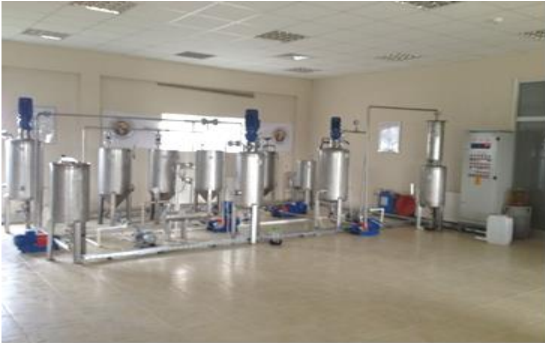
Şekil 3.7. Karadeniz tarımsal araştırma enstitüsü biyodizel üretim reaktörü
