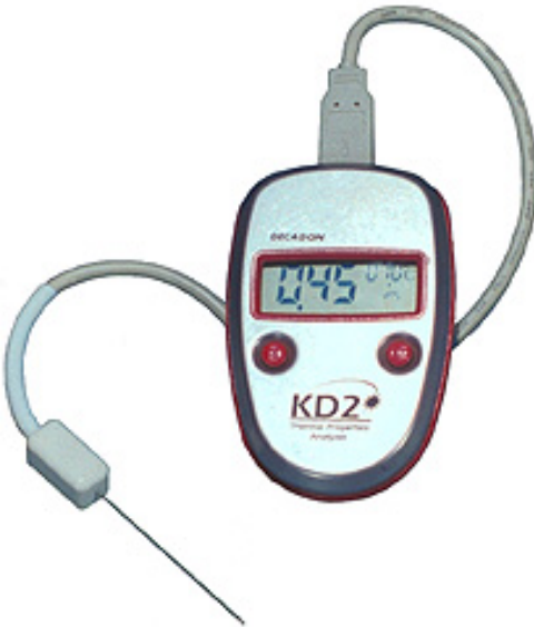
Şekil 3.7. KD2 marka ısı iletkenlik katsayısı ölçüm cihazı
