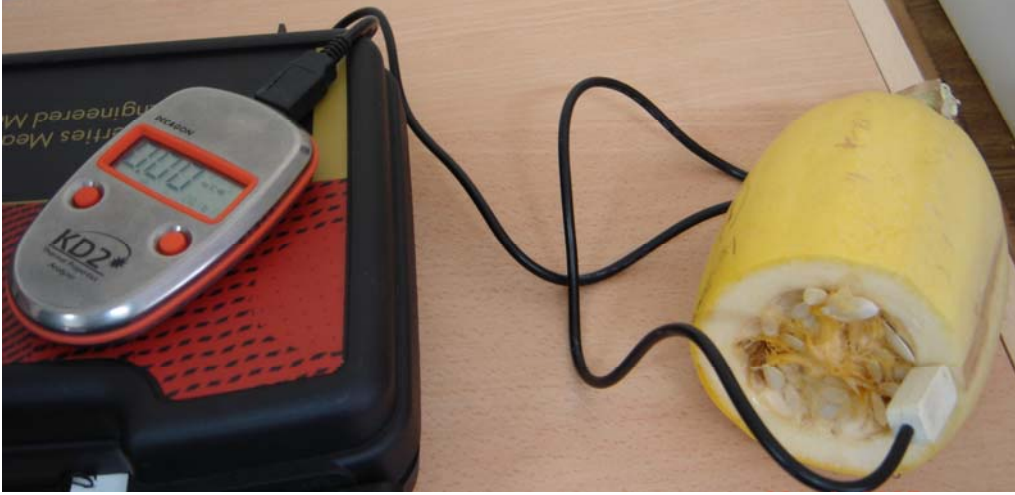
Şekil 3.12. Kabakların ısı iletim katsayılarının ölçülmesi
