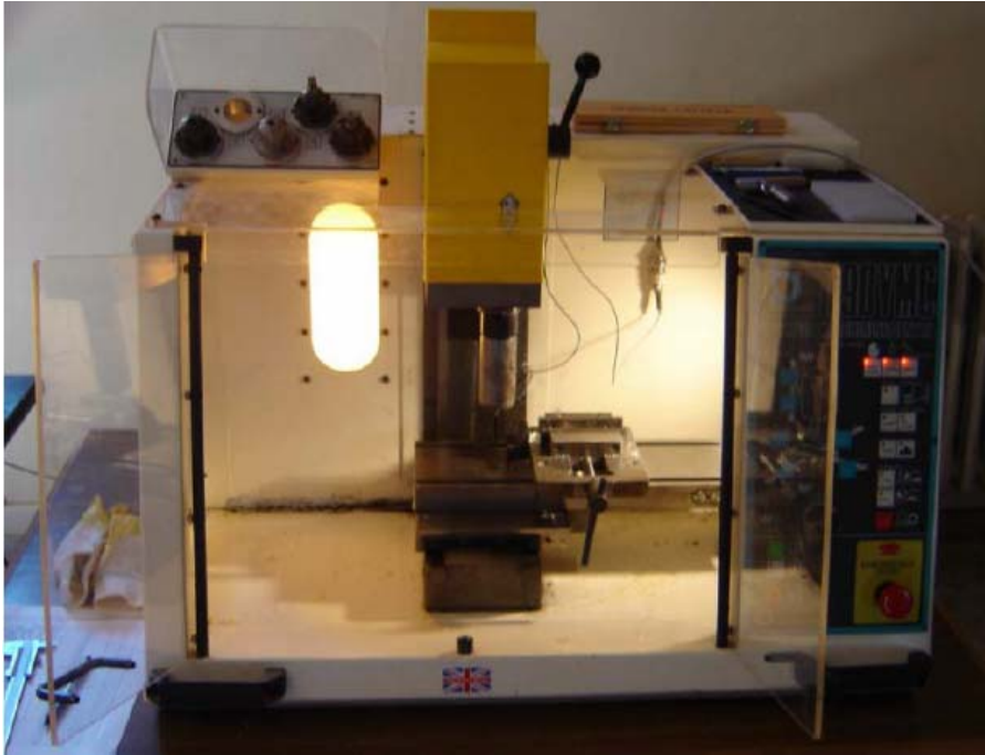
Şekil 3.2. Boxford 190 VMC dikey işleme merkezi
