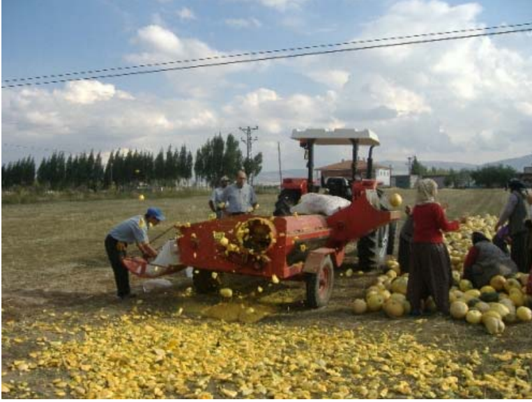
Şekil 1.2. Kabak harman makinasında çekirdeklerin çıkartılması
