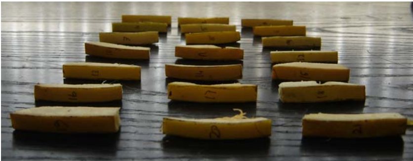
Şekil 3.9. Kabuk kopma deneyi için kullanılan şablonla çıkartılmış kabuklar
