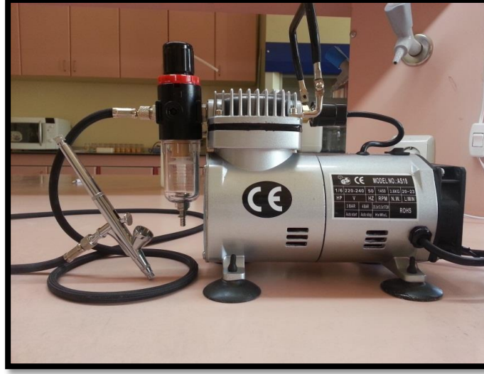
Şekil 2. Biyolojik testlerde yüzey ilaçlaması için kullanılan Airbruch ilaçlama makinesi
