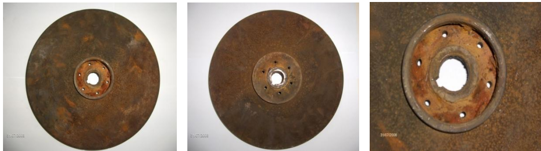
Şekil 13. Çarkın 150 saatlik dönem sonundaki genel görünümü
