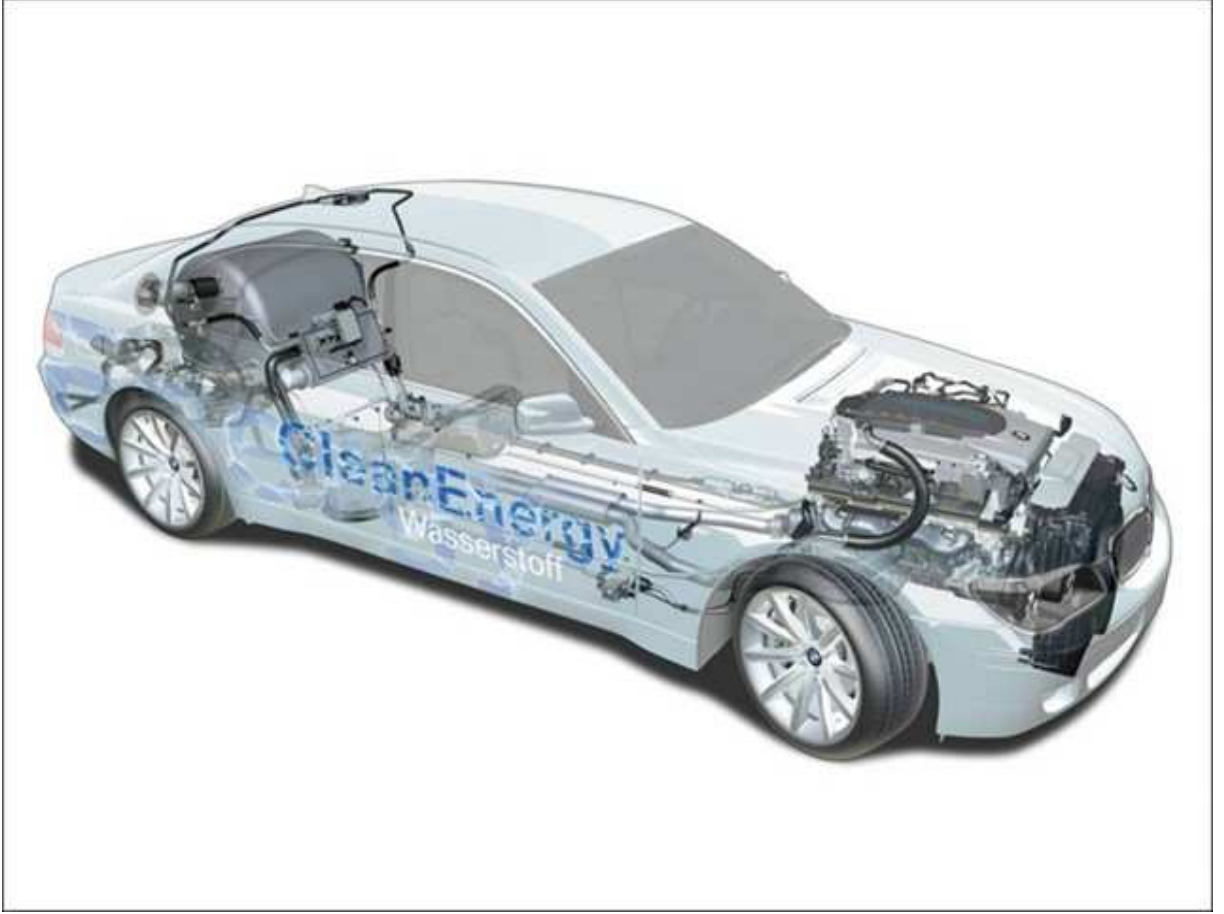
Şekil 1.6: BMW Hydrogen 7'nin şematik görünümü
