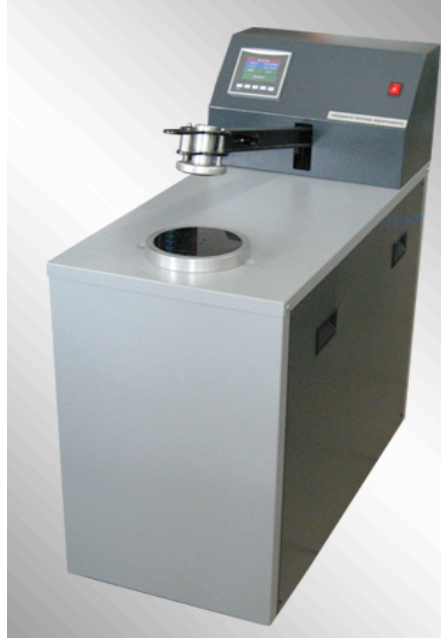
Şekil 4.10. Kumaş hava geçirgenliği test cihazı
