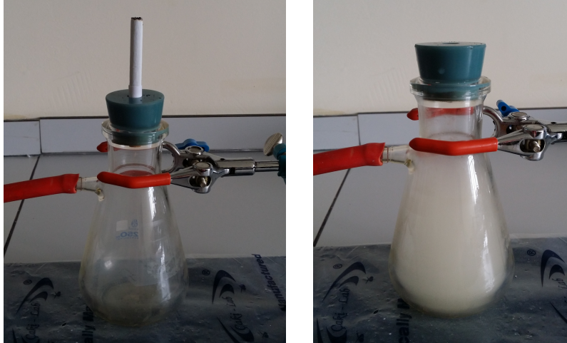
Şekil 5.18. Sadece PP non-woven yüzeyle sigara dumanı filtre edilmeden önce ve sonrasına ait görüntüler
