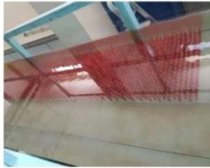
Şekil 4. Parçalı bitkinin kanal içi yerleşimi [10]
