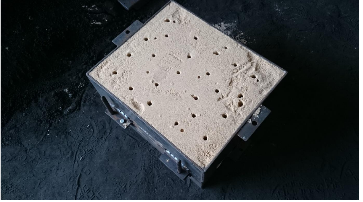
Şekil 3.3 Reçineli kum kullanılarak yapılan kalıp
