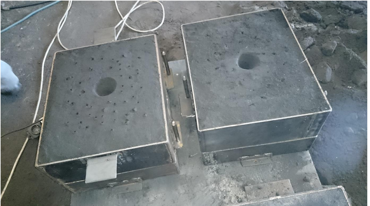
Şekil 3.2 Siyah kumla yapılan kalıp
