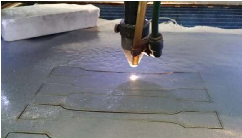
Şekil 3.6. Lazer kesim makinesiyle çekme numunelerin hazırlanması
