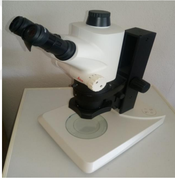
Şekil 2.2 Stereo mikroskop Lecia S8APO (Namık Kemal Üniversitesi)
