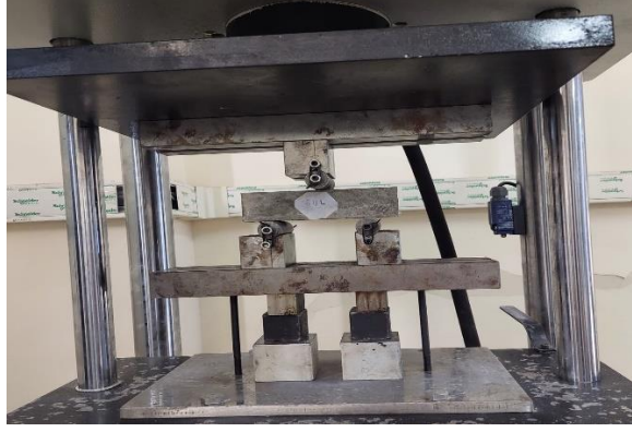
Şekil 3.6. Numunelere eğilme deneyinin uygulanması
