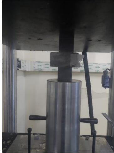
Şekil 3.7. Numunelere basınç deneyinin uygulanması
