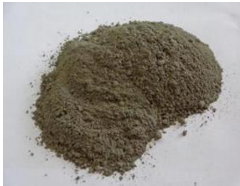
Şekil 3.3. CEM 42.5R Portland Çimentosu
