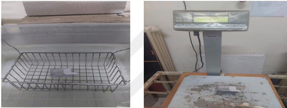
Şekil 3.8. Su emme deneyi cihazı
