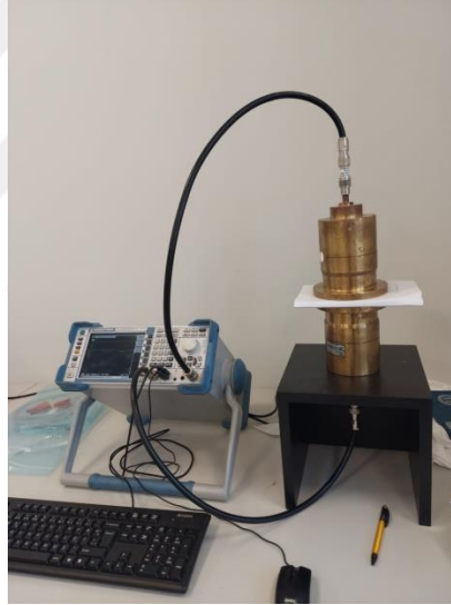
Şekil 3.10. Network Analyzer (ROHDE&SCHWARZ) cihazı
