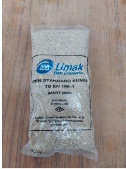
Şekil 3.4. Deneyde kullanılan rilem kumu
