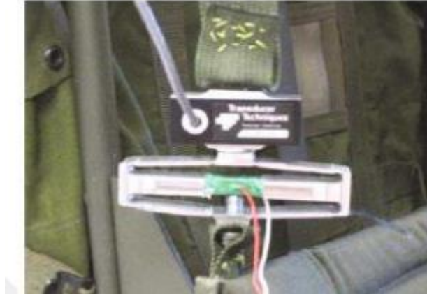
Şekil 2.5. Sırt çantası için tasarlanan piezoelektrik enerji hasatı sistemi (Durgun, 2020)
