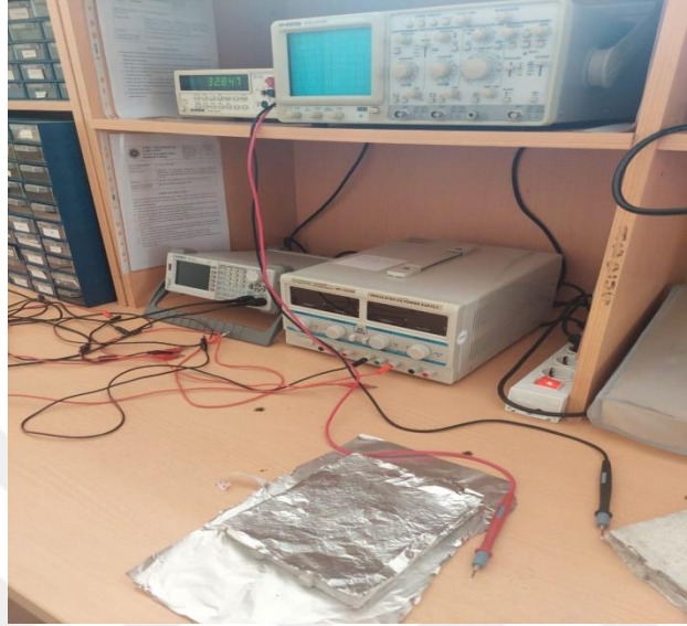
Şekil 3.11. Elektriksel direnç deneyi cihazı
