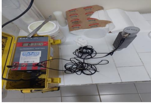
Şekil 3.5. Ultrases geçiş hızı deneyinin uygulanması
