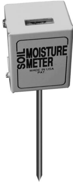
Şekil 3.5. Analog toprak nemi ölçer
