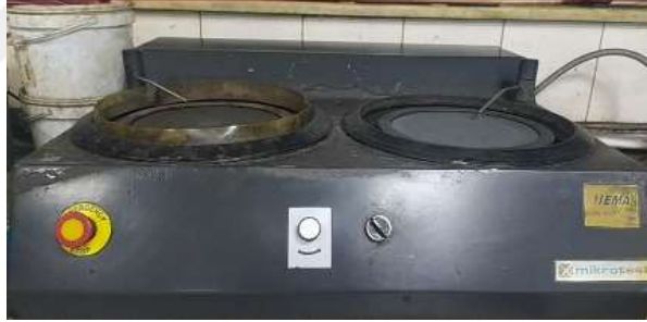
Şekil 6.5. Zımparalama işleminde kullanılan 120'lik ve 400'lük zımparalama cihazı
