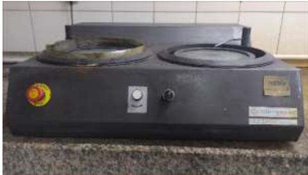
Şekil 6.6. Zımparalama işleminde kullanılan 600'lük ve 1000'lik zımparalama cihazı
