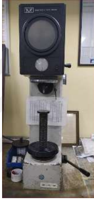
Şekil 6.44. Numunelerin sertlik ölçümü için kullanılan sertlik ölçüm cihazı
