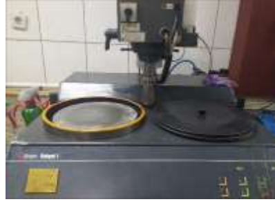
Şekil 6.7. Numunelerin parlatma işleminde kullanılan parlatma cihazı
