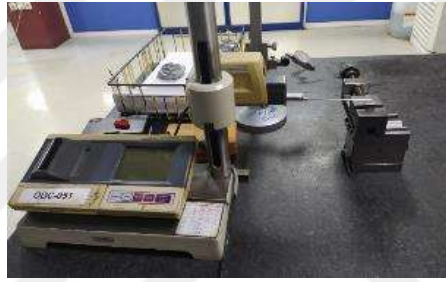
Şekil 6.8. Mitutoyo sj 400 yüzey pürüzlülüğü ölçüm cihazı
