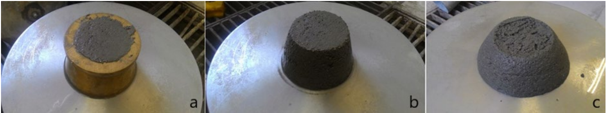
Şekil 3.13. Kesik huniye yerleştirilen harç (a), huniden ayrılan harç (b) ve çapı ölçülen harç (c)
