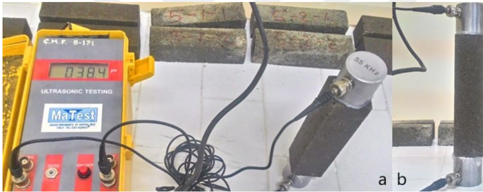
Şekil 3.17. Ultrasonik atımlı dalga hızı deney düzeneğinin üstten görünümü (a) ve yandan görünümü (b)
