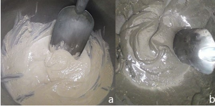
Şekil 3.9. YFC ve \text{Na}_2\text{SiO}_3 solüsyonu karışımı (a) ile YFC, \text{Na}_2\text{SiO}_3 solüsyonu, UK ve NaOH solüsyonu karışımı (b)
