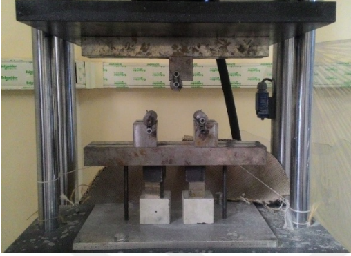
Şekil 3.18. Eğilmede çekme deney düzeneği
