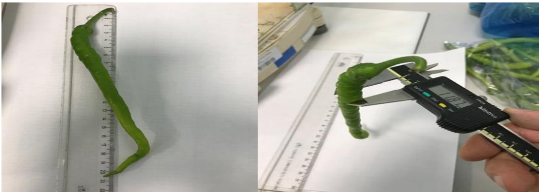
Şekil 2.9. Meyve boy ve çap ölçümleri.
