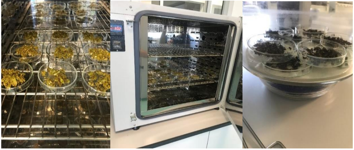
Şekil 2.11. Toplam kuru madde içeriği analiz aşamaları.
