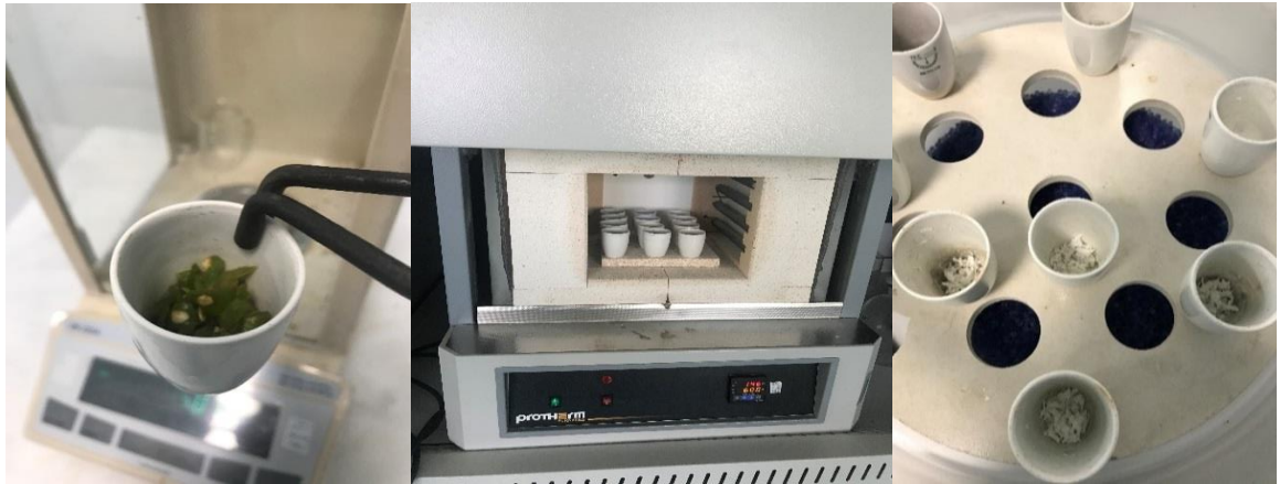
Şekil 2.12. Toplam mineral madde içeriği analiz aşamaları.
