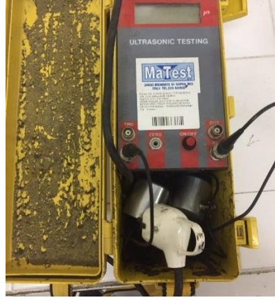
Şekil 2.2. Ultrasonik atımlı dalga hızı deney aleti
