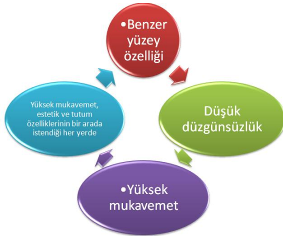
Şekil 2. 3. Özlü ipliğin konvansiyonel ring ipliğinden farkı
