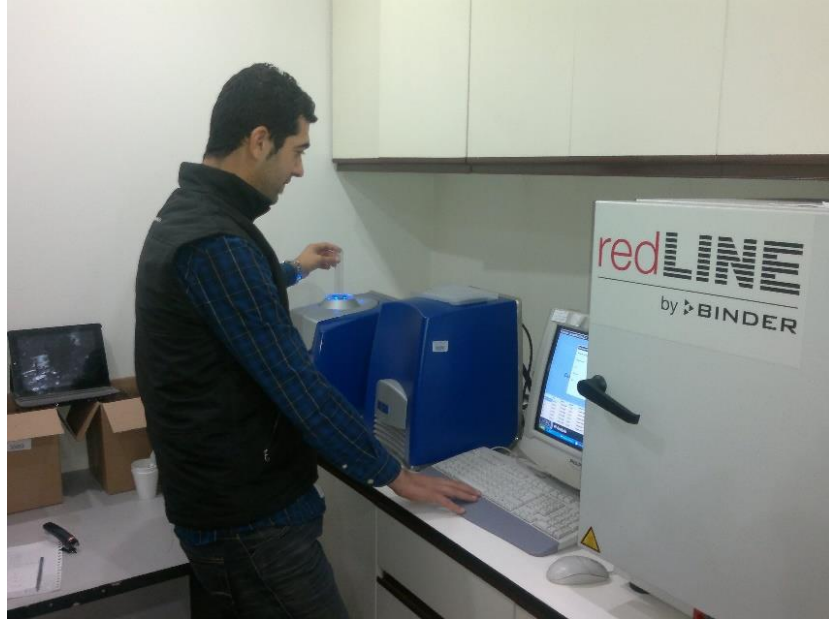
Şekil 4: Ayçiçeğinde yağ analizinde kullanılan NMR cihazı
