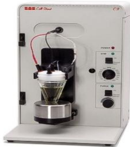
Şekil 2.3 Elektrokimyasal deneylerde kullandığımız polimerleşme düzeneği
