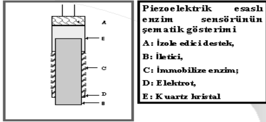
Şekil 2. 5 Bir piezoelektrik sensörü ( Faccio ve ark. 1995) .
